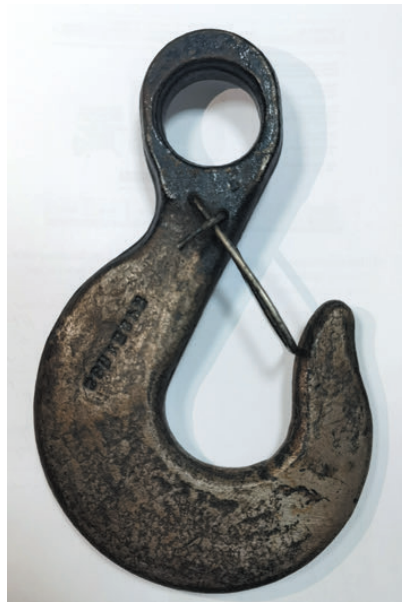
Фото и скан рентгеновского снимка дефектного крюка
