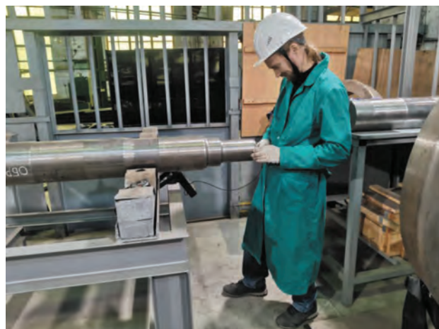
Апробация разработанной методики ультразвукового контроля оси для специального подвижного состава на Камбарском машзаводе
