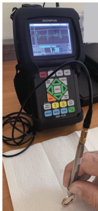
Рис. 2. УЗК золотых изделий толщиномером 38DL PLUS
