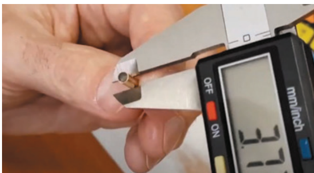
Рис. 6. Золотое изделие с инородной вставкой, обнаруженной по результатам УЗК
