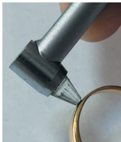
Рис. 3. УЗК кольца из золота преобразователем Sonopen®
