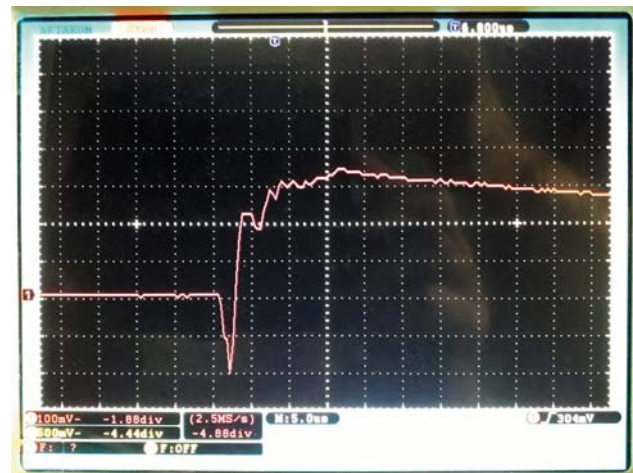
Рис. 1. Осциллограмма акустического импульса имитатора Су–Нильсена. Масштаб по вертикали 100 мВ/дел, масштаб по горизонтали 5 мкс/дел
