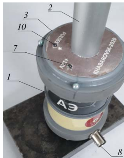
Рис. 6. Фотографии имитатора АЭ-1 и его верхней крышки: 1 – основная часть корпуса (пластик, диаметром 60 мм, высота 70 мм); 2 – дополнительная часть корпуса (дюралюминий, диаметр 19 мм, высота 170 мм); 3 – верхняя крышка корпуса (пластик); 4 – нижняя крышка корпуса (пластик); 5 – подвижный металлический стержень-волновод диаметром 3 мм, выступающий через отверстие в нижней крышке; 6 – закругленный контактный конец стержня-волновода; 7 – красный светодиод, индицирующий наличие электропитания; 8 – разъем для подключения электропитания напряжением 12 В; 9 – разъем для подключения внешнего генератора прямоугольных видеоимпульсов; 10 – зеленый светодиодный индикатор, излучающий импульс света в момент излучения акустического импульса
