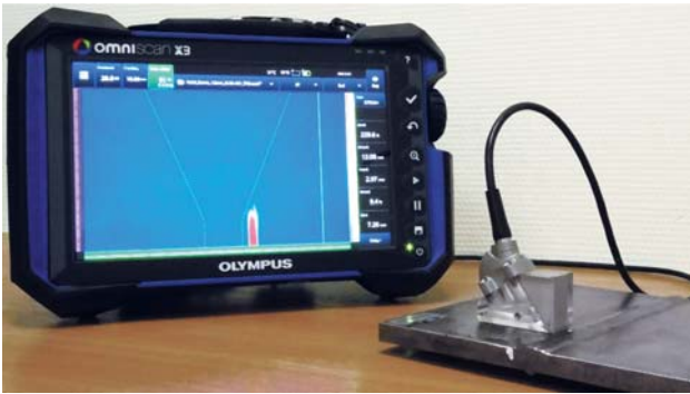
Рис. 2. Дефектоскоп OmniScan X3, ПФР и образец в ходе эксперимента
