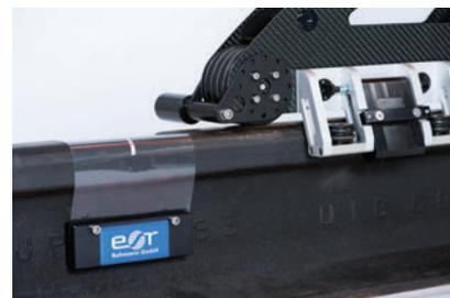
Рис. 3. Калибровочный образец
