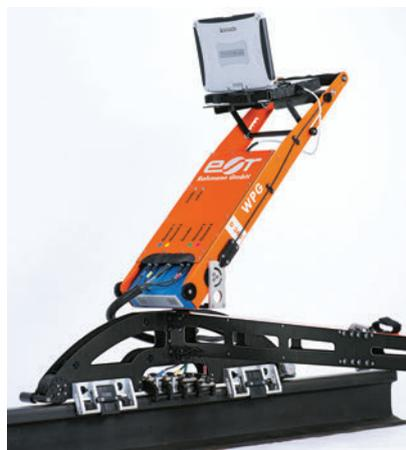
Рис. 1. Вихретоковая система ELO-RAIL
