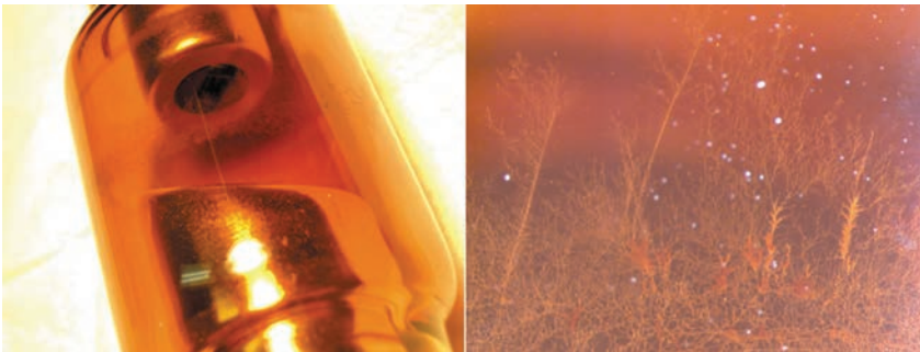
Рис. 9. Стекло с протравлениями, образовавшимися под действием электрического поля
