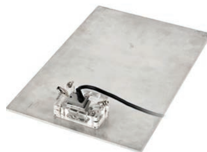
Рис. 4. ФПЭП и призмы поперечной ориентации для выявления поперечных дефектов
