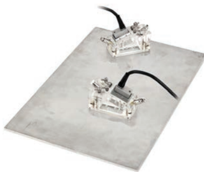
Рис. 3. ФПЭП и призмы нормальной ориентации для выявления продольных и наклонных дефектов
