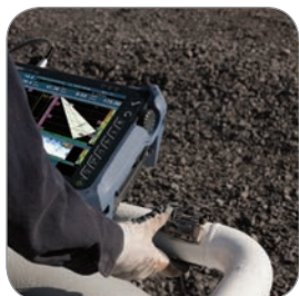
Контроль сварных швов труб малого диаметра
