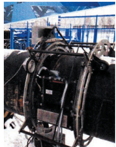
Рис. 2. Комплекс автоматического, цифрового, рентгенографического контроля качества сварных швов труб
