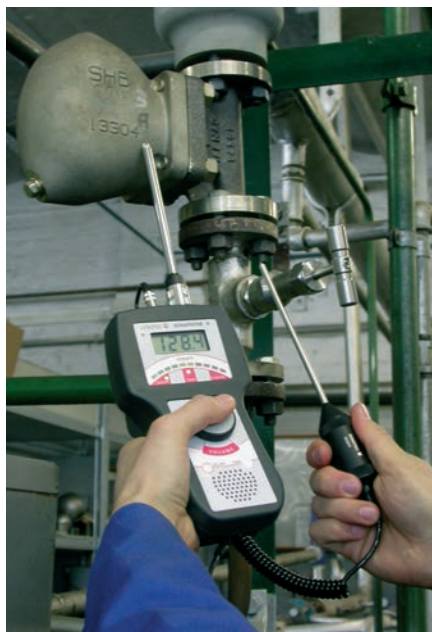
Применение Sonaphone для поиска утечек в паровых системах
