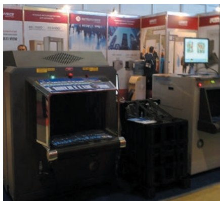
Досмотровые рентгенотелевизионные системы для контроля багажа (РЕЙКОМ Групп – Astrophysics Inc.)
