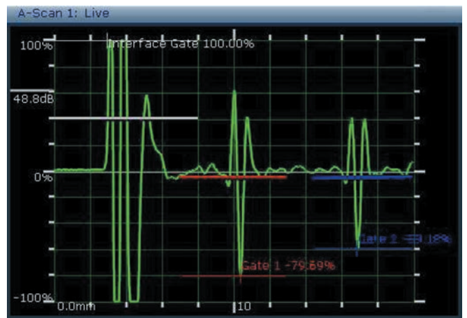
Рис. 6. А-скан, на котором показана настройка стробов
