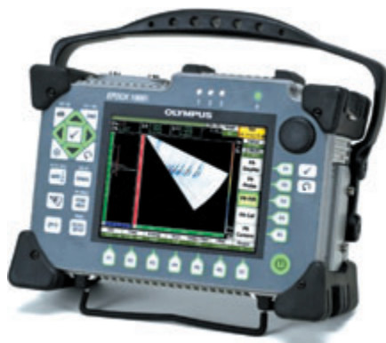
Рис. 5. Ультразвуковой дефектоскоп EPOCH1000i с функцией фазированных решеток
