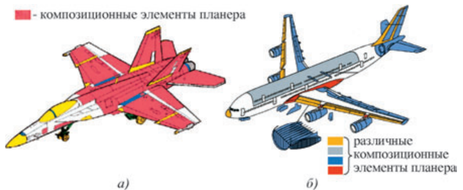
Рис. 3. Композиционные элементы в конструкциях планера боевой и гражданской авиации
