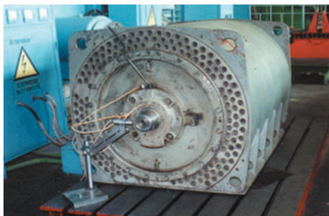
Рис. 2. Система диагностики электродвигателей КОМПАКС®-РПЭ
