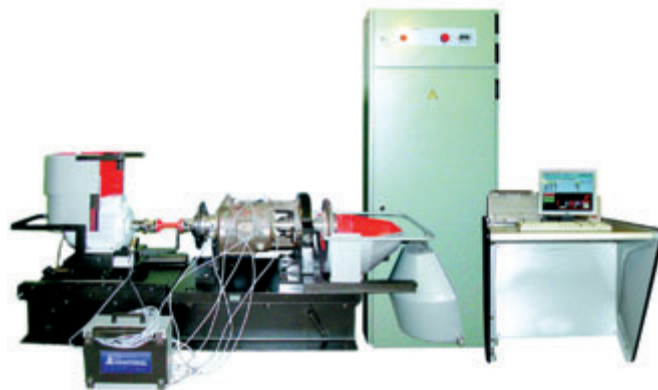
Рис. 1. Система диагностики и динамической балансировки роторов консольных насосов в собственных подшипниках КОМПАКС®-РПМ
