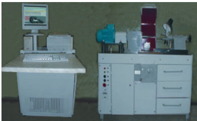
Рис. 3. Система вибродиагностики подшипников качения КОМПАКС®-РПП
