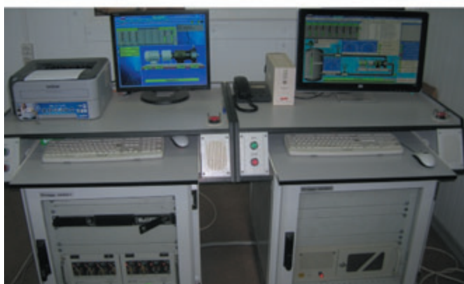
Рис. 5. Система управления испытаниями и диагностики насосных агрегатов КОМПАКС®-РПГ
