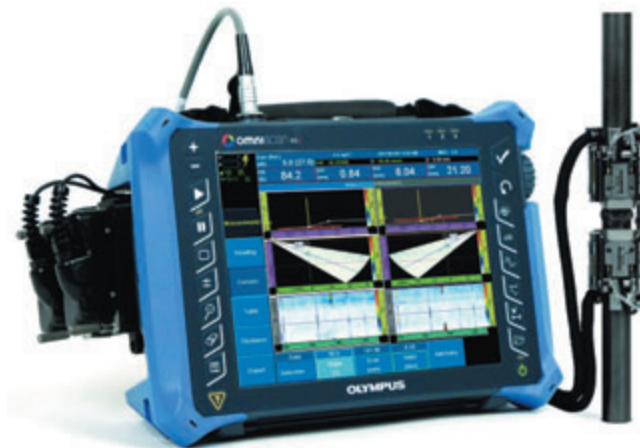
Рис. 1. Комплект (OmniScan MX2 и сканер COBRA™) для контроля труб малого диаметра
