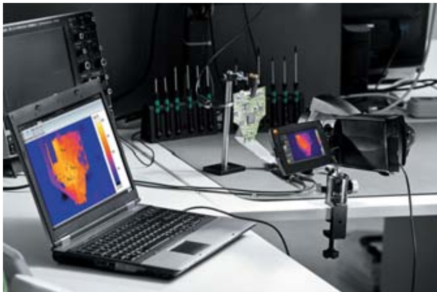
Рис. 5. Использование тепловизора для анализа степени нагрева компонентов на печатных платах
