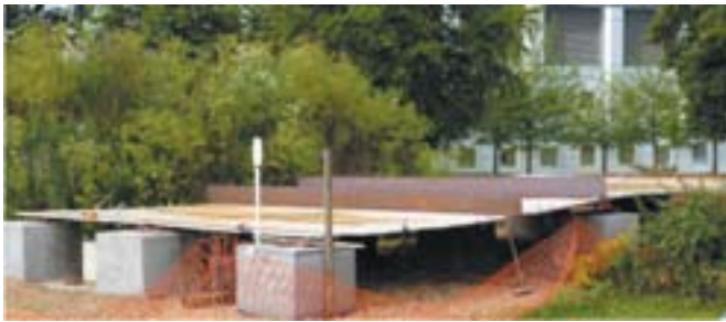
Рис. 4. Образец пластины 12\text{ м} \times 6\text{ м} с элементами жесткости, который использовался в экспериментах по мониторингу поверхности
