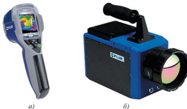
Рис. 1. Современные тепловизоры (не в масштабе, не с целью рекламы): а – тепловизор FLIR i3 (формат матрицы 60 60, спектральный диапазон 7,5...13 мкм, температурная чувствительность <150 мК, полная частота кадров 9 Гц, масса 0,34 кг); б – тепловизионная система FLIR-CEDIP SC7000 для научных исследований (формат матрицы 320 240 или 640 512, спектральный диапазон 3...5 или 8...12 мкм, температурная чувствительность <18 мК, полная частота кадров 380 Гц (до 30кГц в режиме окна), масса 4,95 кг)
