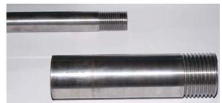
Рис. 4. Стандартные образцы предприятия (СОП) для контроля конической резьбы
